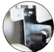
Fotocélula de detección de presencia de cinturón
